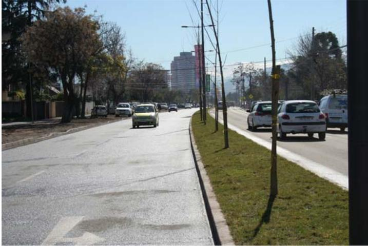
Durante el año 2007 se ejecutaron las obras de mejoramiento del eje Av. Padre Hurtado, entre Camino El Alba y Chesterton, que incluyó el ensanche en todo el tramo para completar el perfil establecido en el PRMS consistente en una doble calzada de 7 m. cada una con un bandejón central segregador de 2 m. de ancho empalmado al perfil existente en el entorno al cruce con Av. Las Condes.
